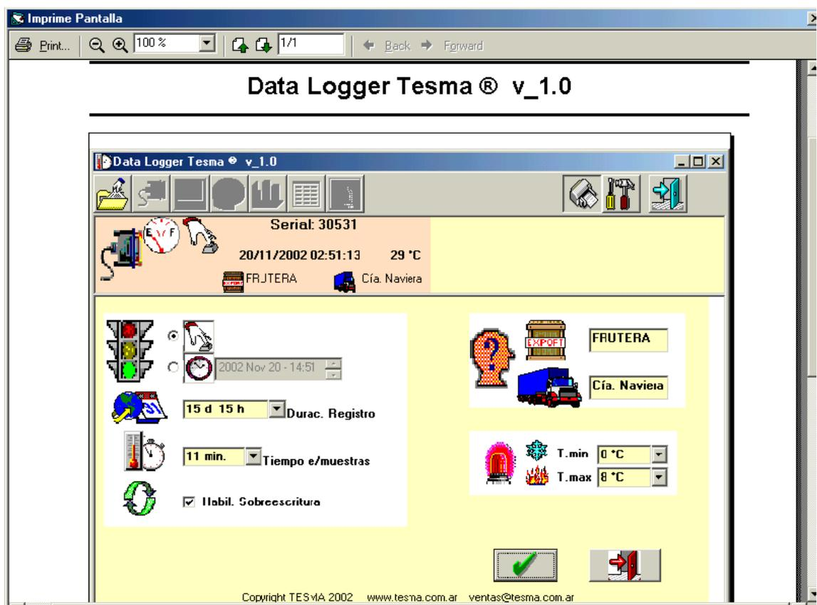
Si queremos observar el estado del TDL, basta con conectarlo a la PC y ésta nos mostrará la pantalla que corresponda al clickear el icono de conexión con el TDL.
